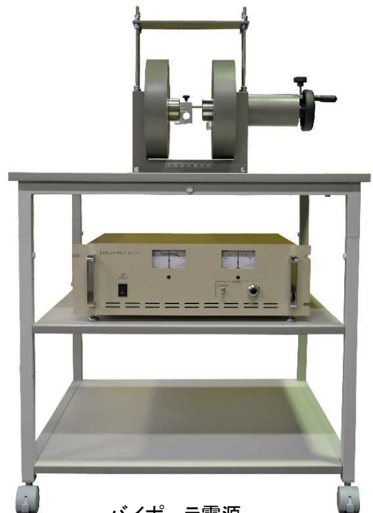
バイポーラ電源 BP-16-03HSP-TM (±3A, ±16V)
