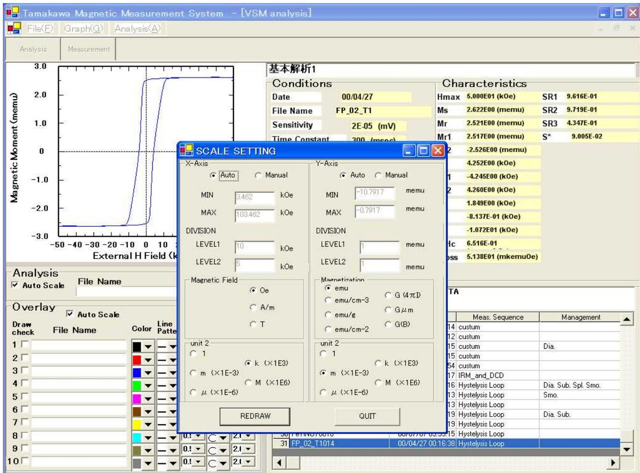
垂直磁化膜測定データ プリント出力例
