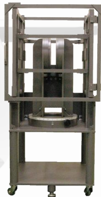
地磁気補償3軸ヘルムホルツコイル (オプション) の組み合わせ例
